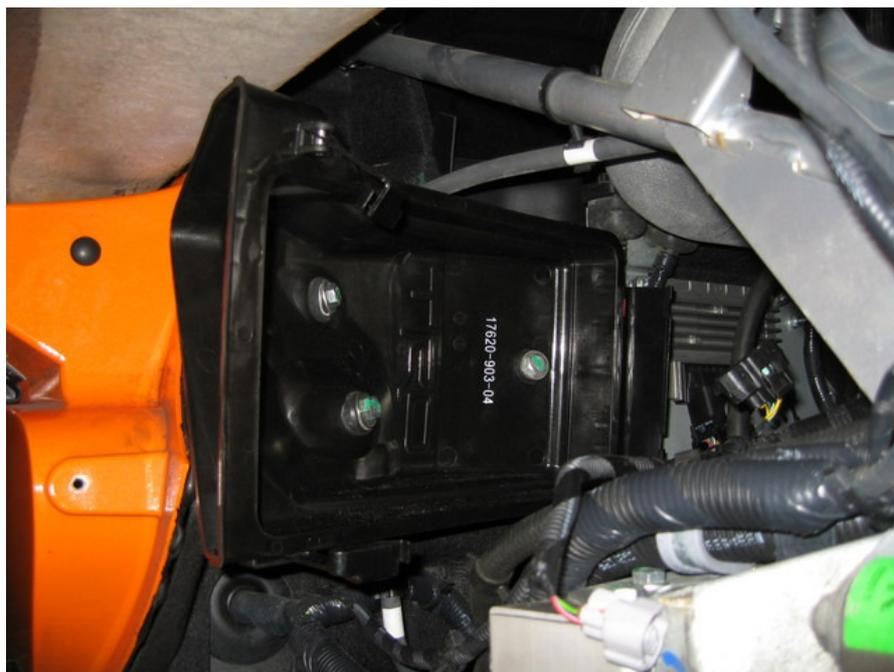
Pour installer correctement la nouvelle boîte, il faut préalablement veiller à plier la partie droite de la pate de fixation (se trouvant sur la coque) car l'emplacement des 2 vis sur la nouvelle boîte est différent qu'à l'origine.
