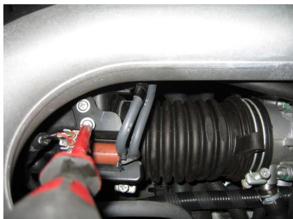
4.3 Déconnecter la fiche sur le module au dessus de la boîte à air. On veillera à isoler ce connecteur une fois la nouvelle boîte remise en place comme ceci:
