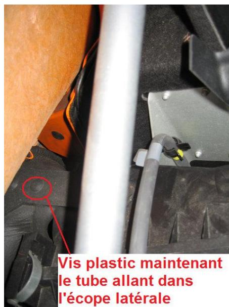
**Vis plastic maintenant le tube allant dans l'écope latérale**
