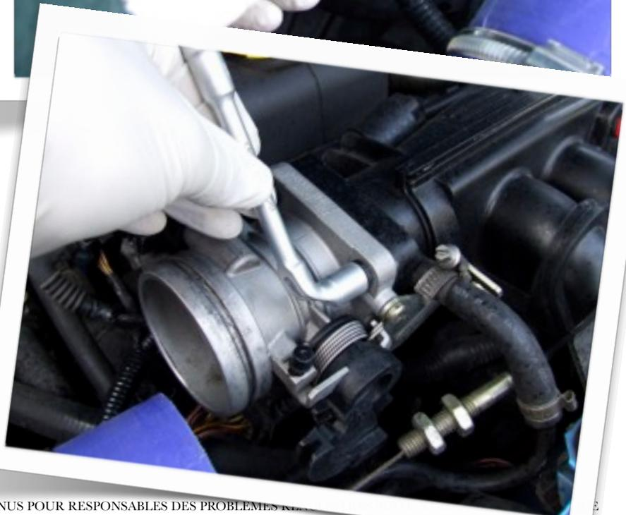
**Retirez les deux gaines silicone.** Celle du bas est fixée par un petit circlip. Vous pouvez mettre un peu de W40 pour faciliter cette opération...
