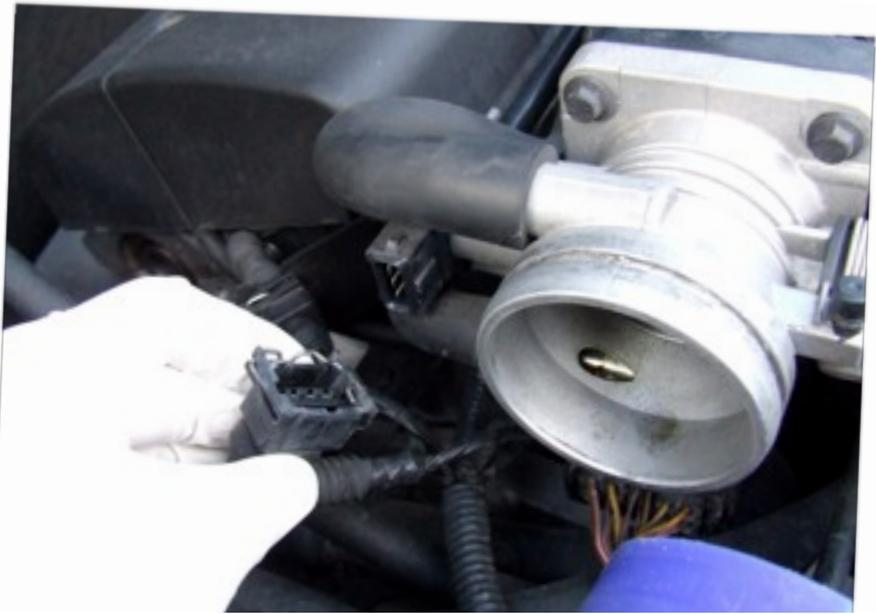
**Dévissez avec une extrême prudence** les 4 vis avec une clef à pipe de 8mm. Attention à la vis en bas à gauche, Elle est difficile d'accès, ne soyez pas aussi con que moi, la mienne est tombé dans ce putain de moteur!!! :- ( Donc au lieu de tenir un satané appareil photo de l'autre main, sécurisez cette vis!!!
