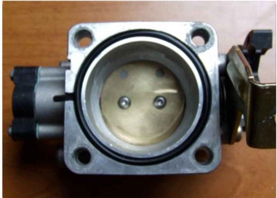
Notez encore une fois le travail sur les angles du corps, toujours adoucir ces angles pour faciliter l'écoulement des flux.
