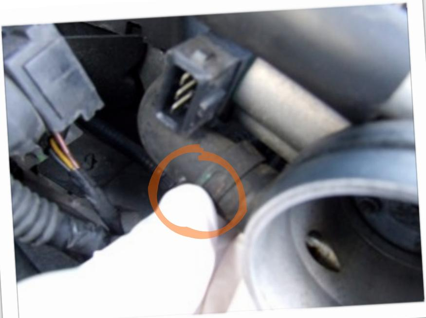
**Retirez l'ensemble** Notez la présence en bas d'un support pour le câblage électronique qui se fixe sur la satanée vis en bas à gauche,
