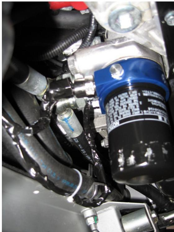
On termine par isoler les câbles avec le tape et les fixer correctement en fonction de l'espace. Il sera bon de faire tourner le moteur et de vérifier si aucune fuite n'arrive au niveau des senseurs, mais aussi au niveau des vis et du filtre/plaque.
