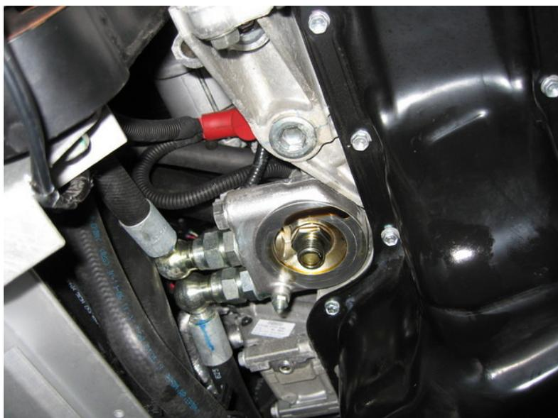
Un récipient est à prévoir pour récupérer les +/- 20cl d'huile s'échapperont, une fois le filtre dévissé. Veiller à déposer le filtre avec précaution vu qu'il est rempli d'huile.
