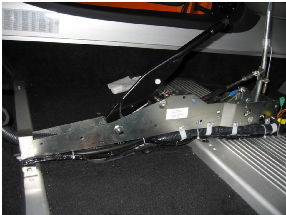
**4.3** On passe par le trou (derrière le cache allume-cigare) et on replace le mousse d'origine
