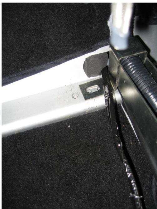
**4.4** On suit le câblage d'origine le long du bas du châssis (usage du petit support en y ajoutant deux rondelles afin de le surélever et de passer le câble en évitant de le compresser)
