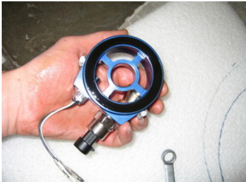
On pourra choisir la position des senseurs, en fonction de l'espace dont on dispose autour du filtre à huile. On dépose une fine couche d'huile sur le joint qui va se positionner donc vers le haut.
