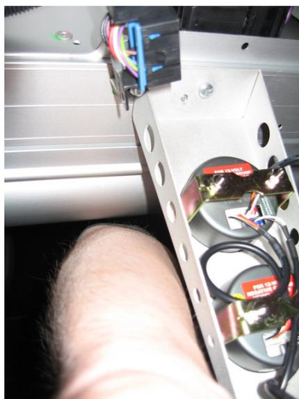
Il faut savoir que le support manomètres se positionnent très bien juste en dessous d'une des vis qui sert au maintien de la fiche de l'ODB. Donc il suffit de percer un trou dans le haut du support des manomètres, ajouter une petite pate de dérive pour maintenir la fiche ODB et le tour est joué!
