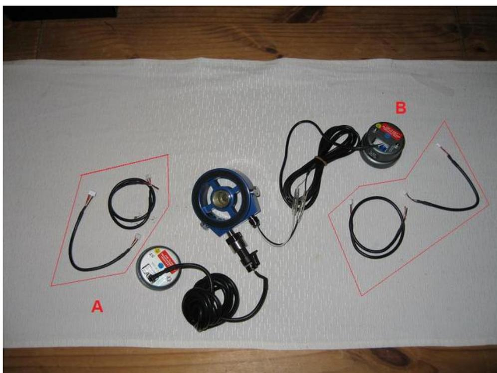
Les câbles entourés de rouge sont en double car ils accompagnent chacun un manomètre. Un seul set suffira. Le câble avec les deux embouts blancs (petits connecteurs) servira de relais entre les deux manomètres, ce qui facilitera le montage car un seul devra être alimenté en courant!
