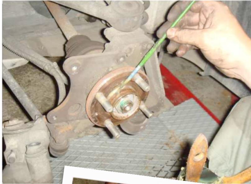
*Avant de monter le nouveau disque passez le à la toile émeri et nettoyez le avec du nettoyant à frein afin d'enlever le dépôt d'huile.*
