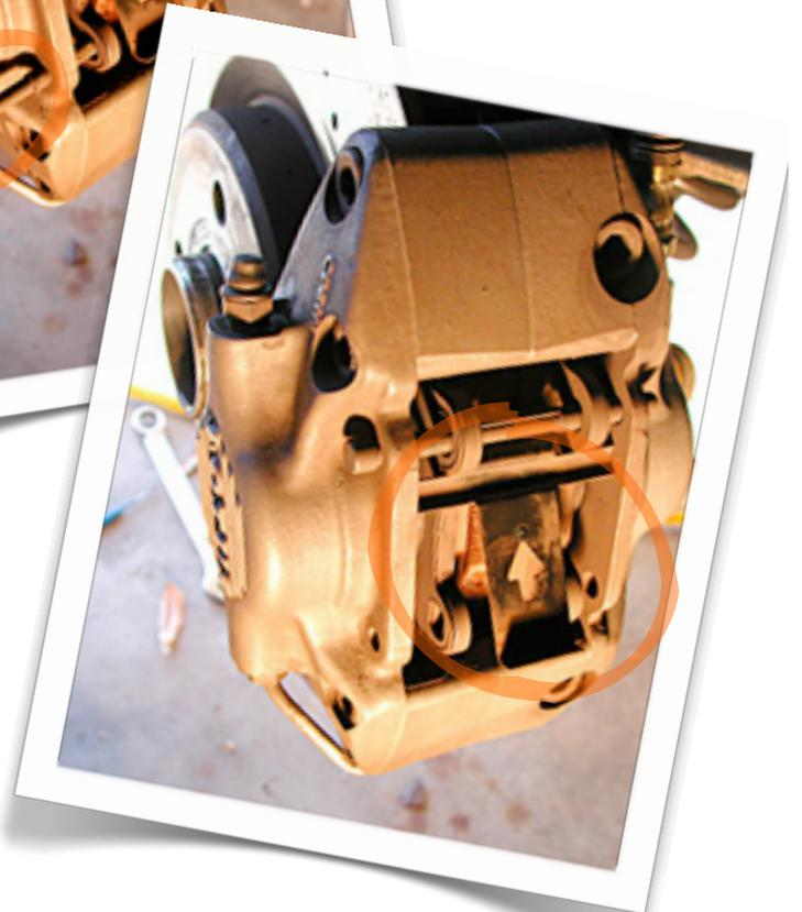
Repoussez légèrement et doucement les pistons avec un tournevis une pince ou un marteau.
