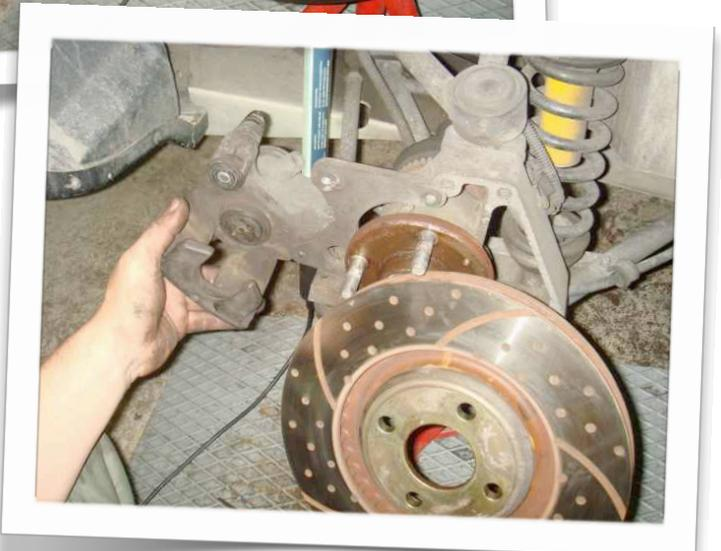
*Il faut dépoussiérer les plans d'appui des plaquettes et très légèrement les graisser pour que les plaquettes puissent se déplacer (c'est un étrier flottant !!)*
