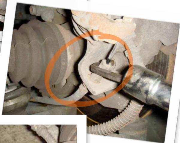
*Démontez la vis et graissez la , une fois remontée elle doit maintenant permettre a l'étrier de flotter très librement*
