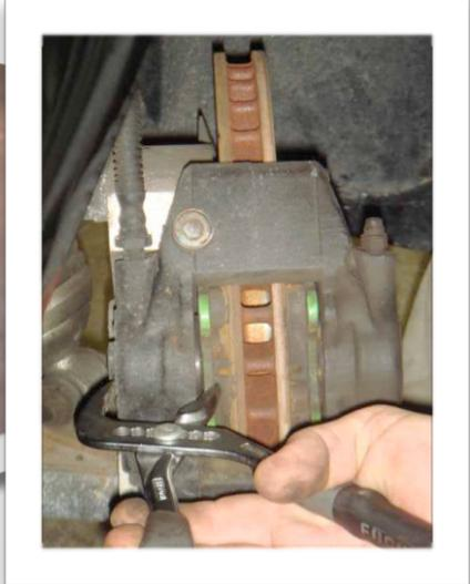
Retirez les plaquettes en les tirant par le haut. Vérifiez si les pistons ne fuient pas, doucement repoussez les au maximum ( quand on rentre un piston l'autre sort, c'est assez pénible mais prenez votre temps ) puis nettoyez l'étrier avec du nettoyant à frein.
