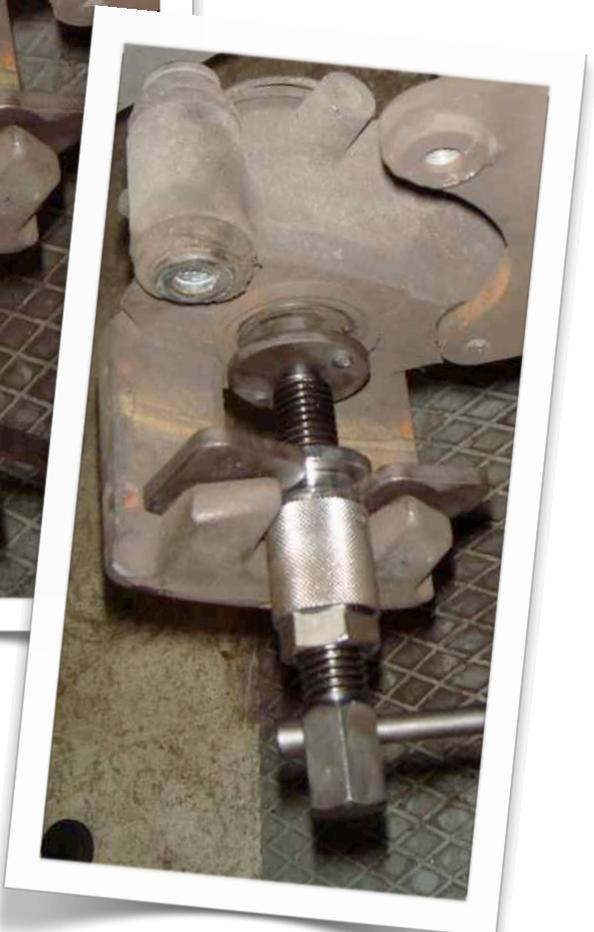
*vérifiez que l'étrier coulisse (flotte) si se n'est pas le cas démontez la deuxième vis qui tient l'étrier avec une clé à allen*
