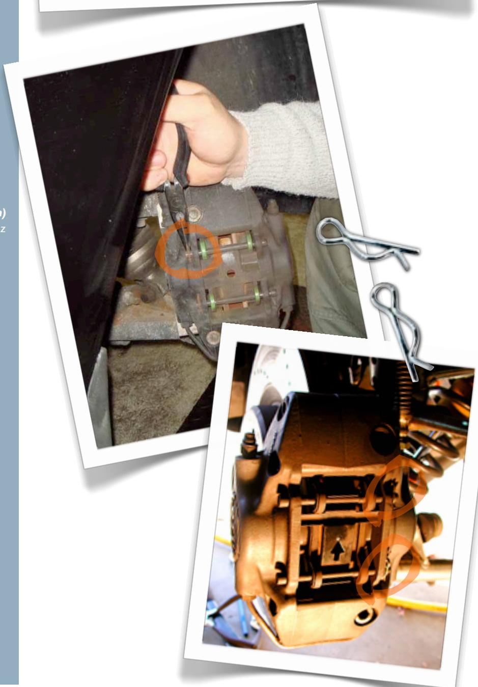
**Retirer les deux goupilles** (pad securing pin). Avec un marteau et un chasse goupilles enlever les deux goupilles et la plaque ressort (anti rattle spring plate).
