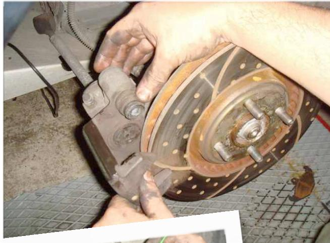
*Montez le disque en prenant soin de graisser légèrement le moyeu*
