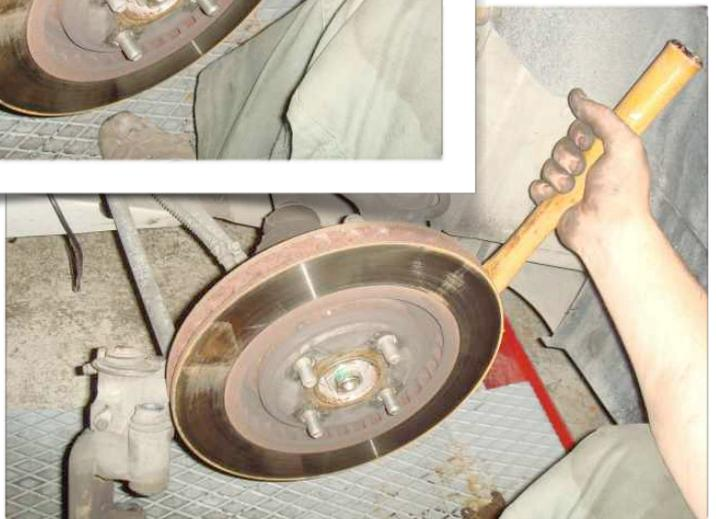
*Nettoyez le moyeu et déposez un peu de graisse sur la bague du moyeu ( ça sera plus facile à démonter la prochaine fois !! )*
