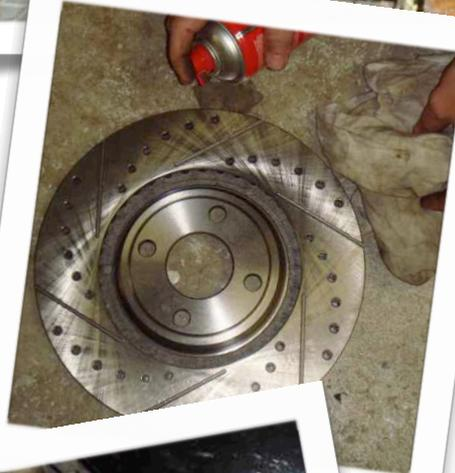
*Montez le disque , (sans vous tromper de sens) et remontez l'étrier en mettant si possible du frein filet sur les vis*
