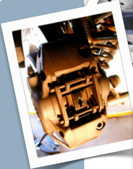
*Pompez sur la pédale de frein afin que les pistons viennent en position. Vérifiez le niveau de liquide de frein et refermez le bocal remontez les roues. Faites un petit rodage frein car il faut que les plaquettes épouse parfaitement le disque pour obtenir un freinage correct.*
