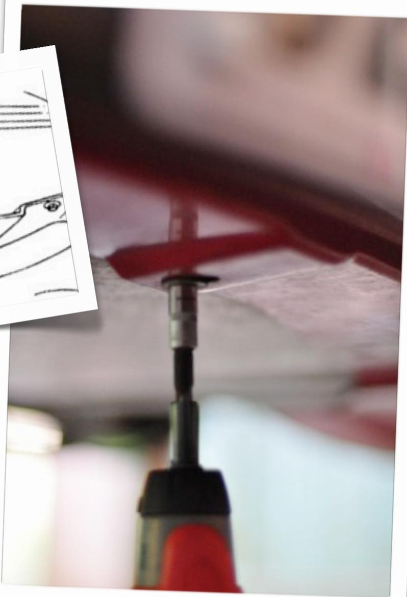
Dans les passages de roues, à l'avant de la roue, dévissez les deux vis/clip en plastique
