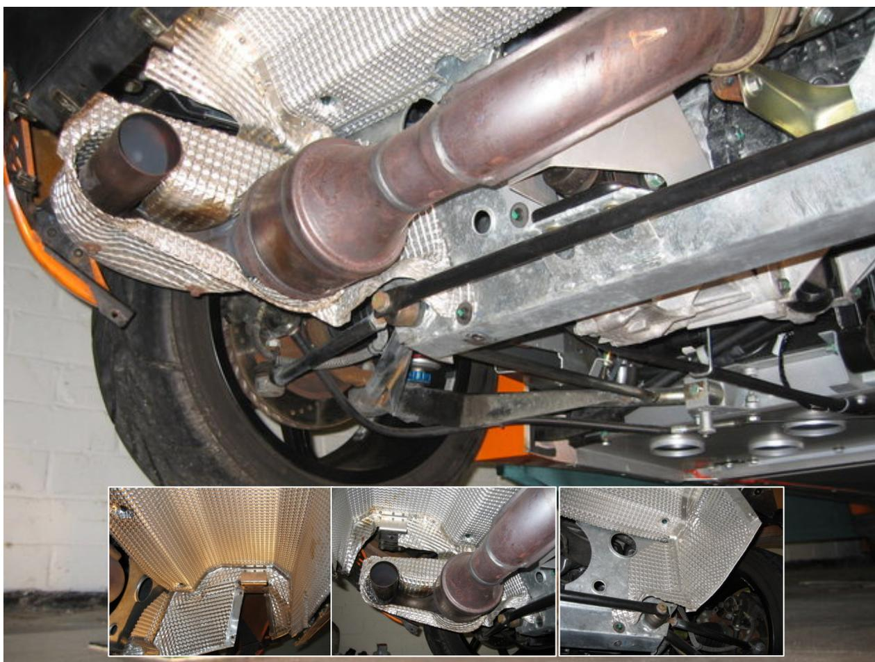
Conseil: Vérifier l'usure des silent blocs et remplacer les éventuellement par des silent blocs en silicones (+ plus résistants).
