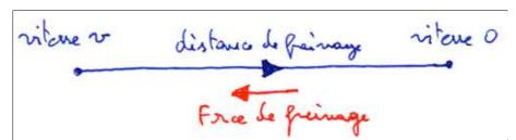
Énergie dissipée pendant le freinage = force de freinage x distance de freinage  $E = 1.3 \text{ mg} \times \text{d}$
