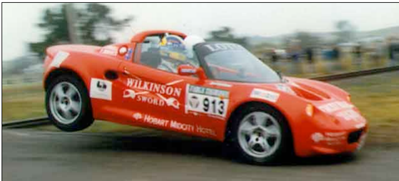
en freinage une accélération horizontale vient se rajouter à la pesanteur cette valeur peut aller jusqu'à 1.3g
