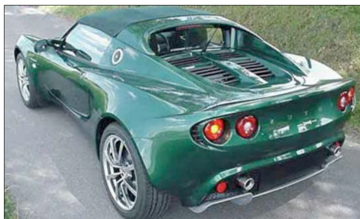
les nervures intermédiaires canalisent le flux d'air en direction longitudinale ; le diffuseur dépasse largement à l'arrière de la voiture
