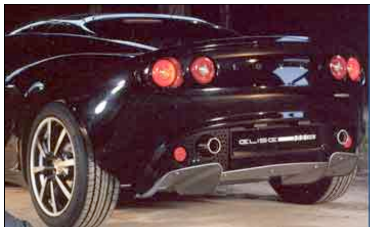
les nervures intermédiaires canalisent le flux d'air en direction longitudinale ; le diffuseur dépasse largement à l'arrière de la voiture
