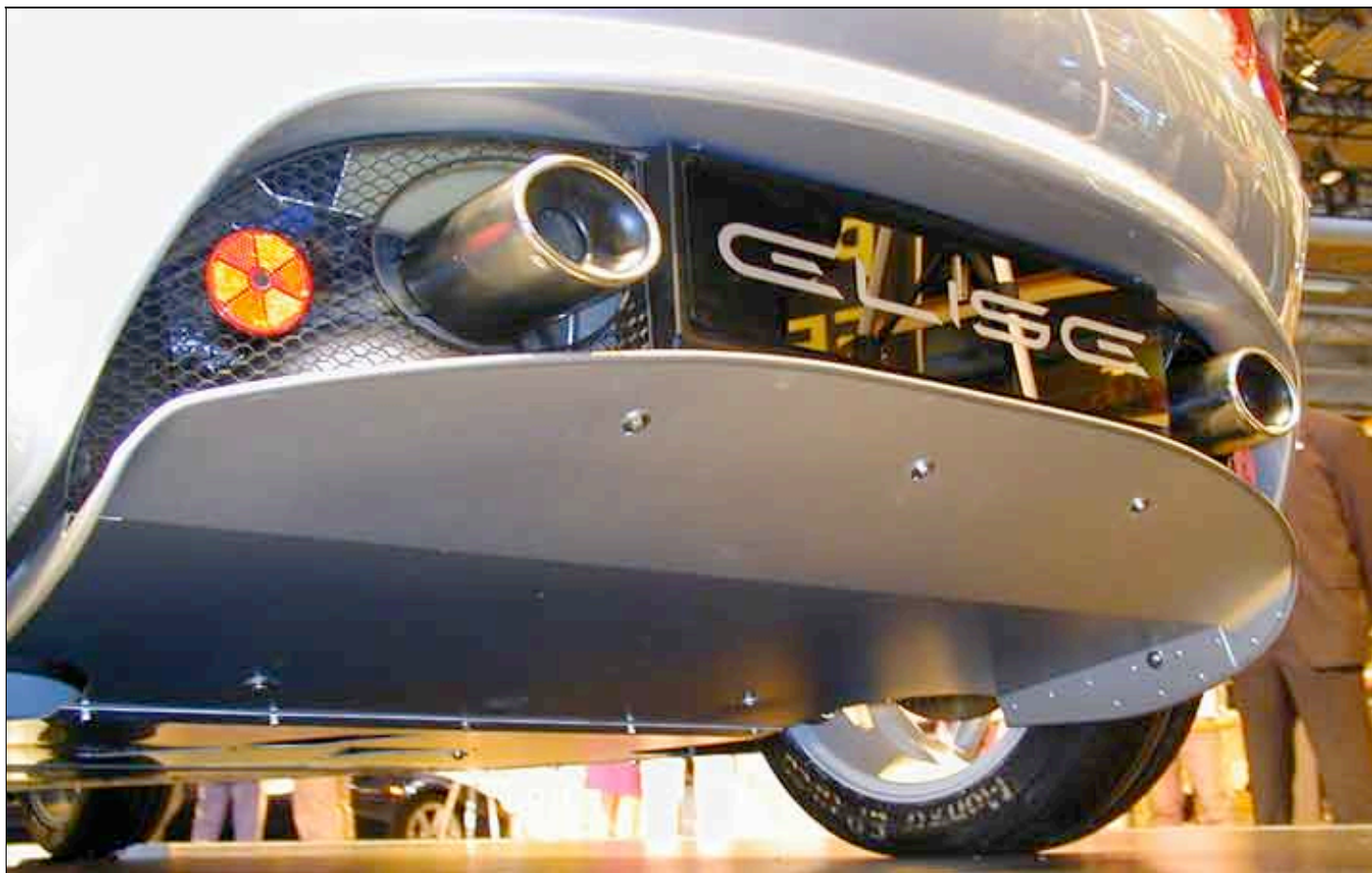
le premier diffuseur de la New Elise, sans nervures intermédiaires
