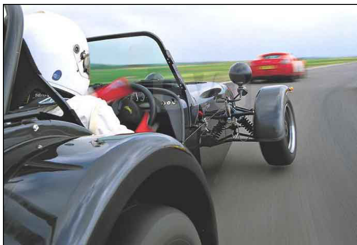
la barre anti-roulis va jusqu'à faire lever la roue avant intérieure...
