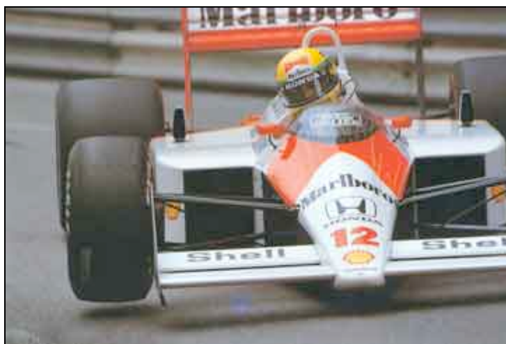
la barre anti-roulis va jusqu'à faire lever la roue avant intérieure...
