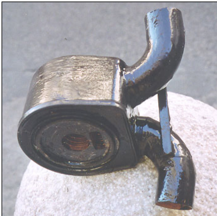
à gauche, l'échangeur seul, à droite, monté entre le support de filtre à huile et le filtre à huile
